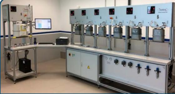
**音速喷嘴式燃气表检定装置**
